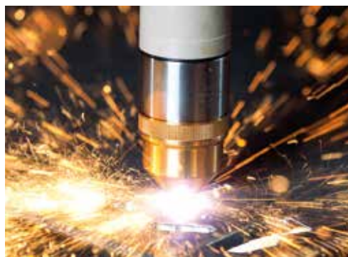
Präzisionsplasma mit automatischer Gaskonsole ermöglicht das Schneiden von Löchern in Messer Hole Technology.
