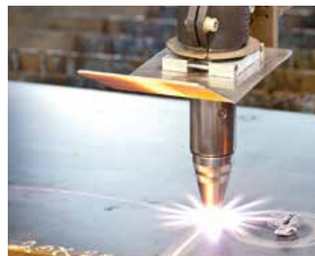
Für dickeres Material bietet sich das Autogenschneiden an. (Option)
