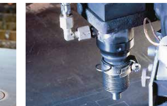
Der optionale Hochfrequenz-Körper ermöglicht genaues Markieren von Punkten und Linien.
